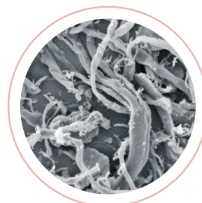
Сканирующая электронная микрофотография микрочастиц коллагена материала COLLOST® micro
